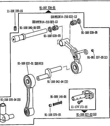
PIN-tucking part set Dispositif à nervures Dispositivo para alforzas -915/... tor · para PFAFF 418
